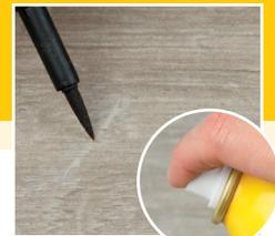
**DE Vorbereiten:** Alle losen Teile entfernen. Bei Echtholzoberflächen Schadensränder rund drücken. Bei künstlichen Oberflächen (wie z.B. Melamin, PVC, usw.) Schadensränder gerade nach unten mit dem Kantennagel abstechen.
